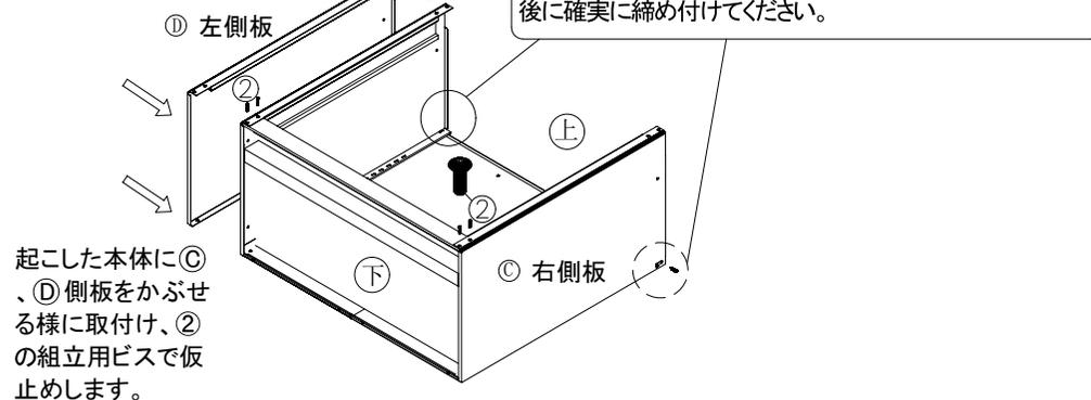
起こした本体に③、④側板をかぶせる様に取付け、②の組立用ビスで仮止めます。
