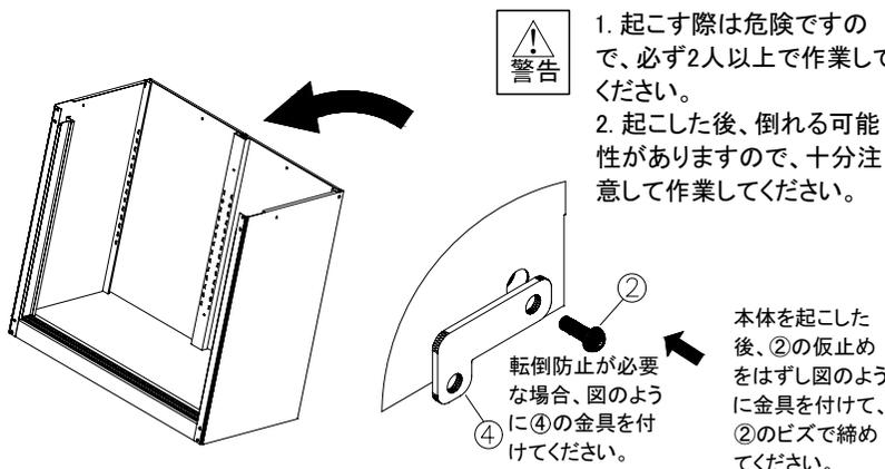
本体を起こした後、②の仮止めをはずし図のように金具を付けて、②のビスで締めてください。
