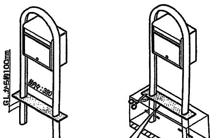
②基礎穴を掘り、水平、垂直出入りを確認し、コンクリートで固定してください。
