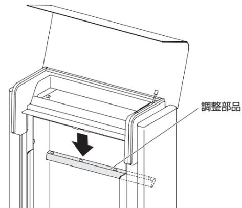
投函口のサイズを通常に戻す場合は、取りはずし時と逆の手順で調整部品を取付けてください。
