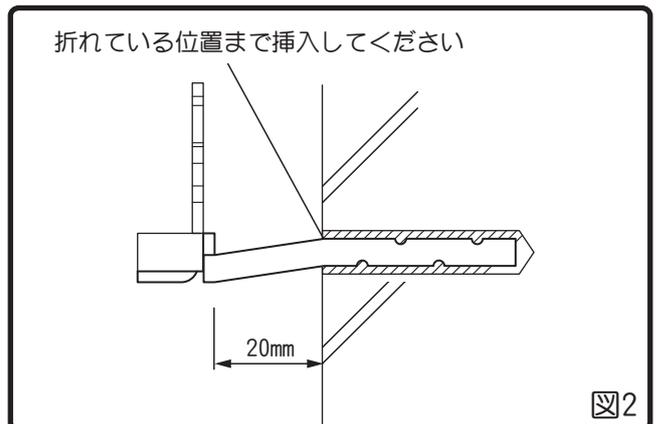
■ 施工手順 [ファンクションティンバーに取付ける場合] ※必ずエポキシ接着剤を使用して下さい。
