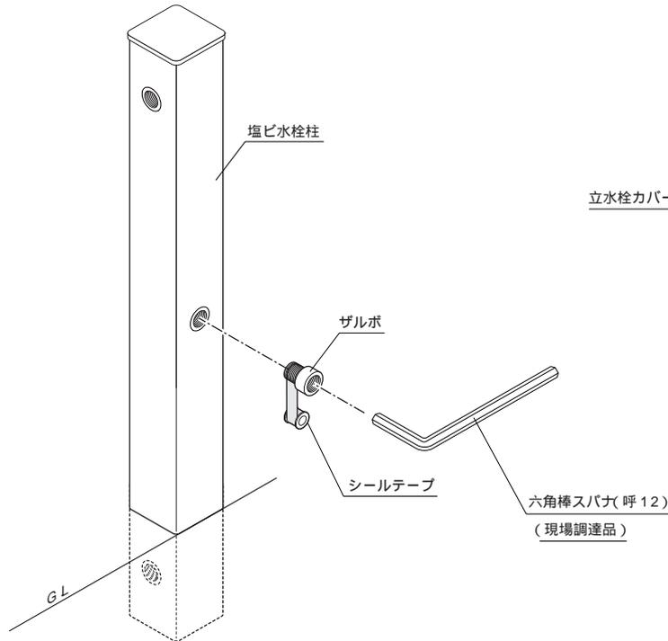
本体キャップをはずし立水栓カバーを塩ビ水栓柱の上部よりかぶせます。
