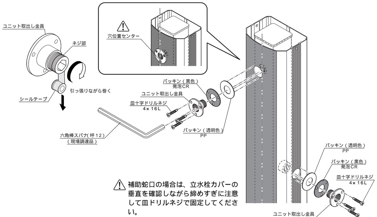
⚠️ 補助蛇口の場合は、立水栓カバーの垂直を確認しながら締めすぎに注意して皿ドリルネジで固定してください。
